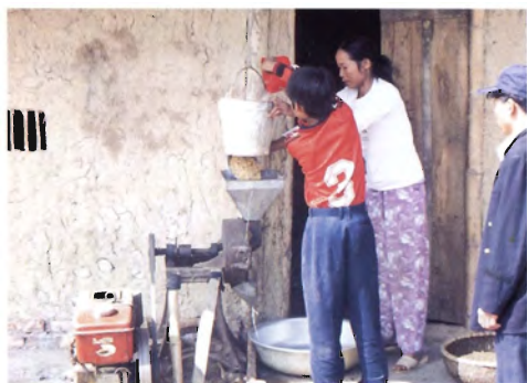
Dien Bien郡の農家ででの豆乳作り。動力式の磨砕機で、水に浸したダイズから豆乳をしぼる。
