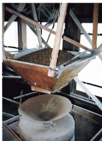
福井県大野市，中道さん宅のソバを製粉する石臼。少しずつ実が落ちるように工夫されている。石臼には動力がついている。
