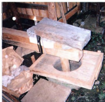
岩泉町有芸で復元された「バッタ」(水力を利用した臼)ヒエの精白に使う
