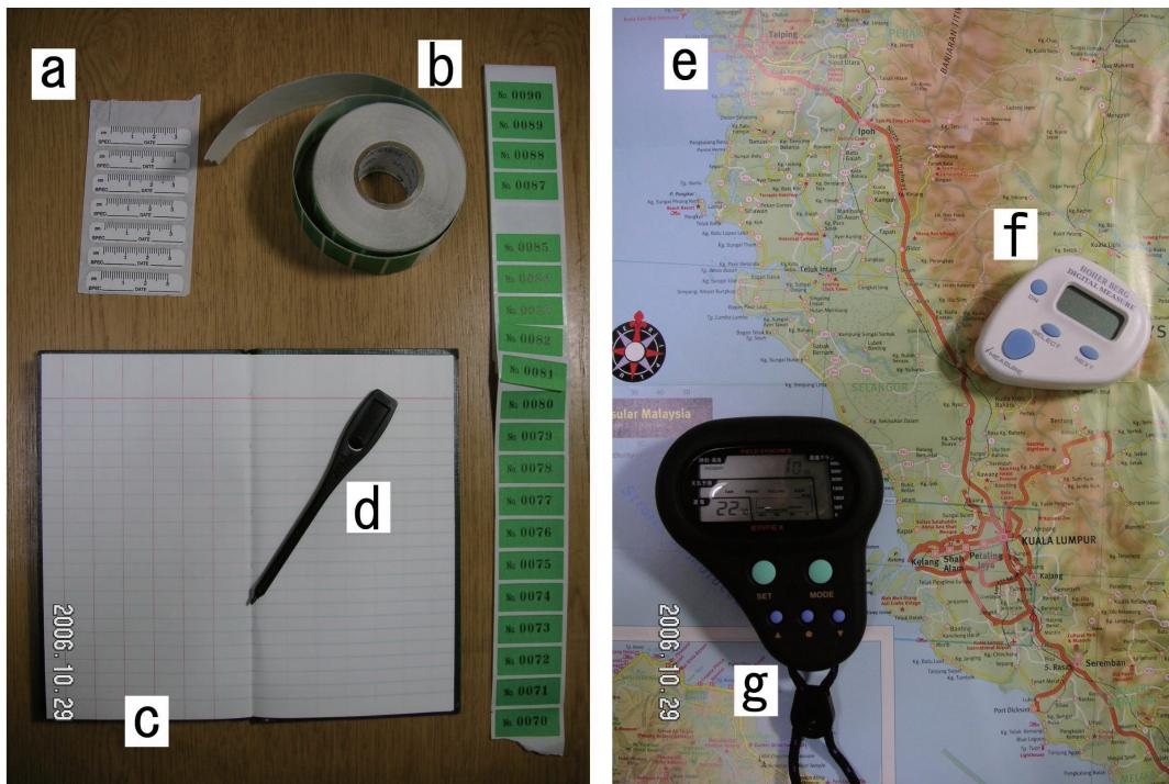
図1. 採集用品の例 . a. 写真用スケールシール (30mm), b. 採集番号シール (Nos. 1-999), c. 採集記録野帳, d. 筆記用具 (Pegg), e. 地図, f. マップメジャー, g. デジタル高度計
